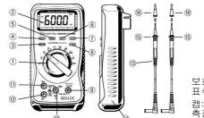
①기능 전환 스위치 ③MIN / MAX키 ⑤RANGE키 ⑦HOLD키 ⑨측정단자 (V/Ω/Hz) ⑪측정단자 (10A) ②표시부 ④SELECT키 ⑥REL키 ⑧Hz/DUTY키 ⑩측정단자 (COM) 연측정단자 (mA) ⑭홀스터 ⑯캠
