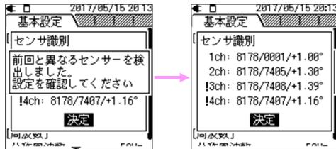
범용의 누설 전류 검출형 클램프 센서 및 부하 전류 검출형 클램프 센서는 자동 설정할 수 없습니다. 수동으로 설정하여 주십시오.
