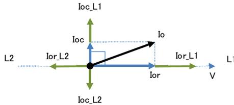
$I_{or\_L1}$ ,  $I_{or\_L2}$ 는 각각 L1 상, L2 상의 대지 저항 성분 누설 전류,  $I_{oc\_L1}$ ,  $I_{oc\_L2}$ 는 각각 L1 상, L2 상의 대지 용량 성분 누설 전류를 나타내고 있습니다. L1 상과 L2 상이 동시에 절연 열화된 경우에는 L1 상과 L2 상의 전압이 각각 역위상 때문에,  $I_{or}$  이 없어지게 되지만, L1 상과 L2 상이 동일한 정도로 동시에 열화하는 것은 극히 드물기 때문에 각각 단상에서 판단할 수가 있습니다. 열화된 상을 특정하는 것은 벡터도를 참고하여 주십시오.  $I_o$  의 벡터 방향에 의해 열화의 가능성이 있는 상을 추측할 수 있습니다.
