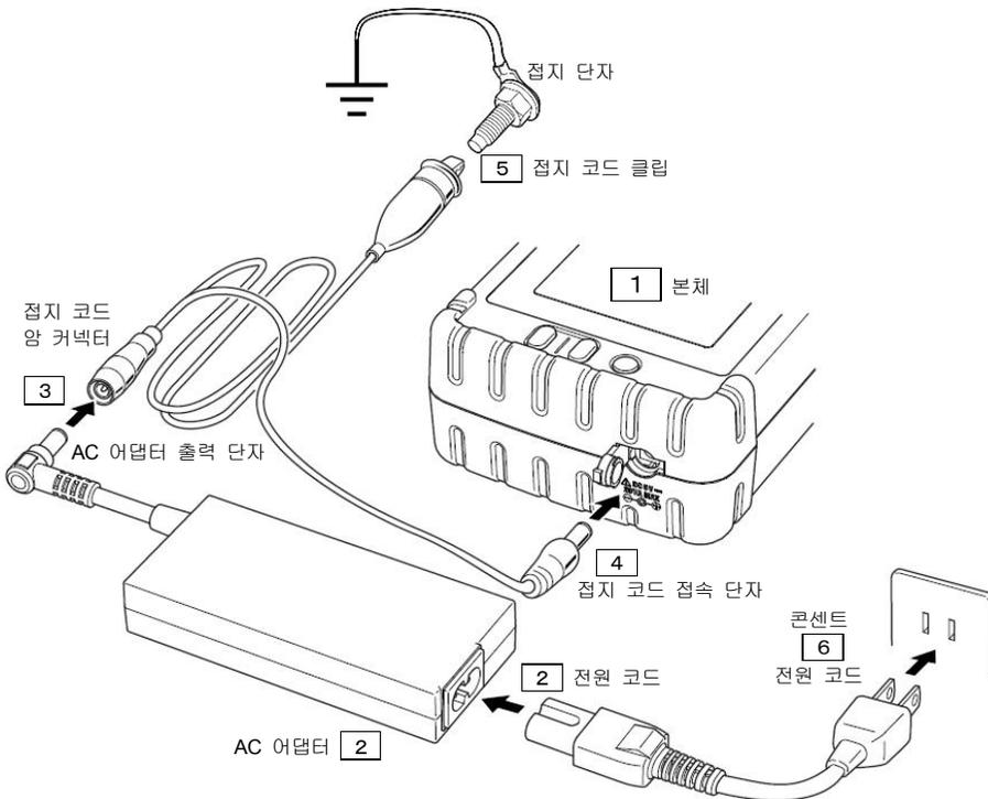
옵션의 전원 공급 어댑터 「MODEL8329」를 사용하여 대기전압 240V 이하의 측정 라인에서, 전원을 공급할 수가 있습니다. 상세는 9.3 「측정 라인에서 전원 공급하기」 79 페이지를 참조하여 주십시오.
