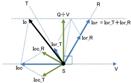
$I_{or\_R}, I_{or\_T}$ 은 각각 R상, T상의 대지 저항 성분 누설 전류,  $I_{oc\_R}, I_{oc\_T}$ 은 각각 R상, T상의 대지 용량 성분 누설 전류를 나타내고 있습니다.  $I_o$  및 기준 전압 실효값(V)의 허수와 실수에서 무효 전력값  $Q$ 를 구하고, 거기에서  $V$ 를 제거한 값을 기준으로 합니다.  $I_{or}$ 은 R상 전압 및 T상 전압에 대해 동위상으로 흐르고,  $I_{oc}$ 는  $I_{oc\_R}$ 과  $I_{oc\_T}$ 와 평행 상태에 있다고 하면,  $V$ 에 대해 역위상으로 흐르기 때문에, 위 그림과 같은 벡터 관계로 되고, 다음의 식에서  $I_{or}$ 이 구해집니다.
