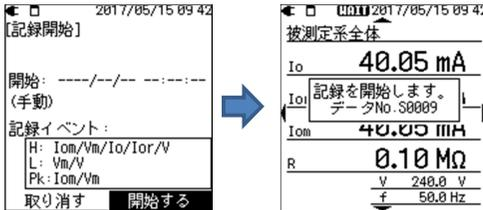
기록을 개시하기 전에 현재의 기록 설정을 표시합니다. 변경할 필요가 없는 경우에는 「개시하기」를 선택하여 주십시오. 현재의 설정에 준하여 기록을 개시합니다. 기록 설정을 변경하려면, 일단「취소」를 선택하여 기록을 취소한 다음에 **SET UP** 「기록 설정」에서 변경하여 주십시오. 또, 측정 전에는 반드시 『안전의 확인』, 『측정 준비』를 실행하여 주십시오.
