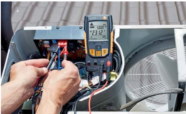
실외기의 전압 측정을 위한 디지털 멀티메타 testo 760
