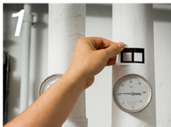
측정대상에 반사스티커( \epsilon -marker)를 붙이고, 열화상 카메라를 실화상 모드로 전환합니다.
