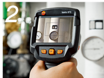
측정대상의 방사율( \epsilon )과 반사온도(RTC)를 자동으로 인지해 설정합니다.
