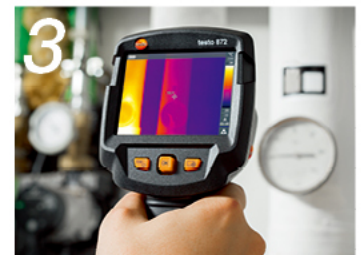
정확한 방사율( \epsilon )과 반사온도(RTC)가 적용된 열화상 이미지를 확인할 수 있습니다.
